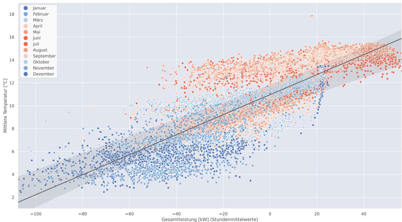
Abb. 7 Thermische Antwort der Anlage auf Lastanforderungen (Thermal Response), inklusive linearer Regression über Stundenmittelwerte
